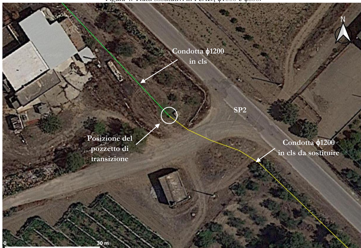
Figura 5. Posizione prevista del pozzetto di transizione a monte del tratto da sostituire.
