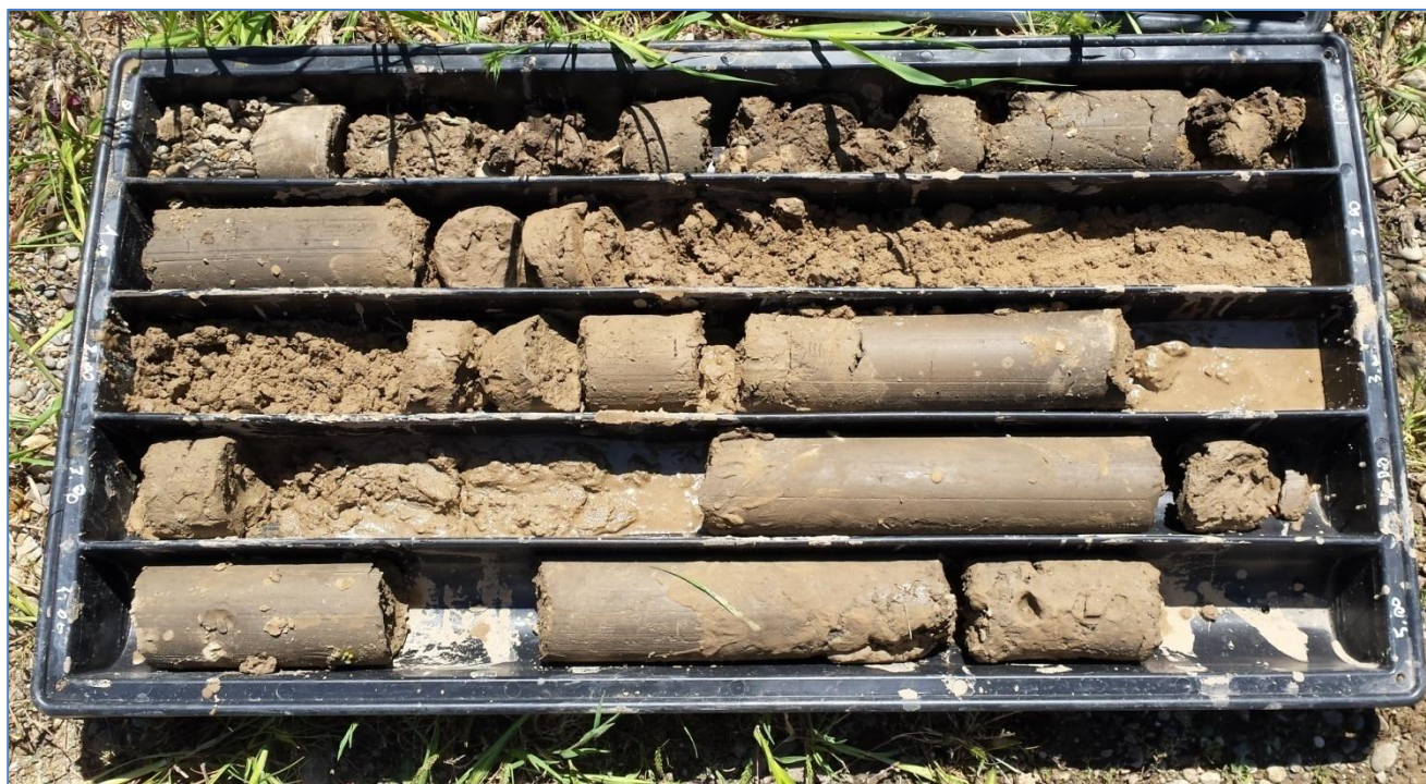
FIG. 7B STRATIGRAFIA DA 0 -5 M - SONDAGGIO S2
