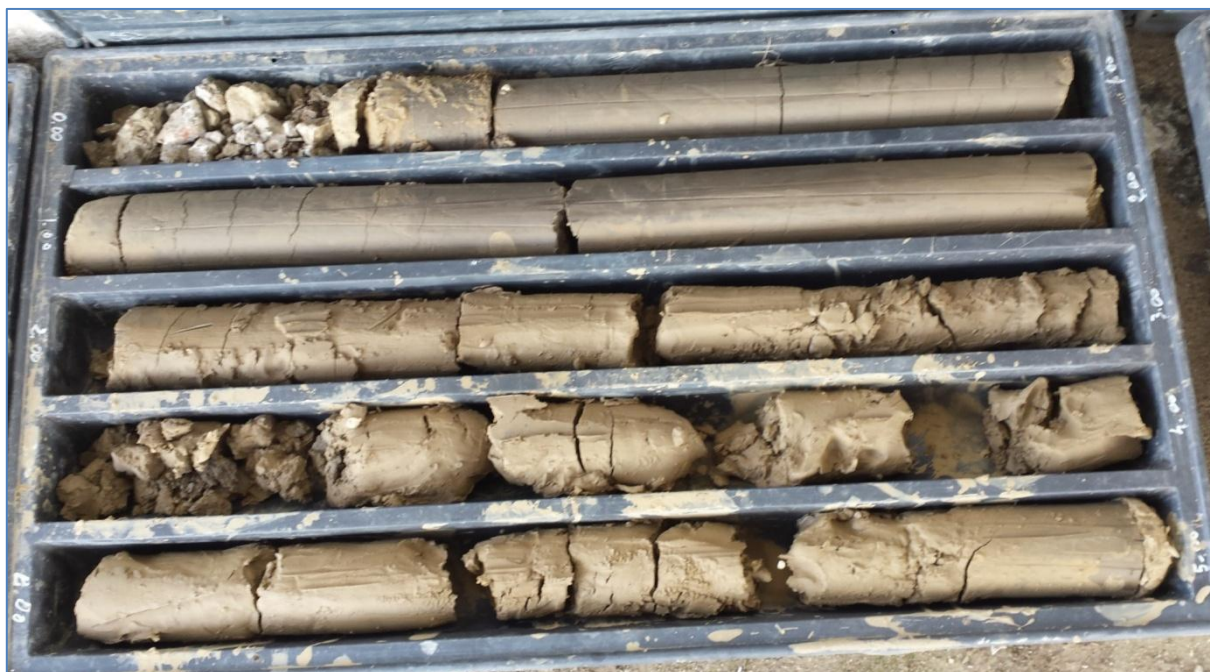
FIG. 12B STRATIGRAFIA DA 0 -5 M - SONDAGGIO S7
