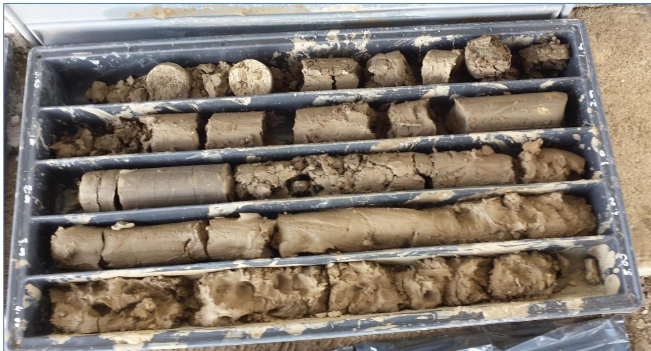
FIG. 11.B STRATIGRAFIA DA 0 -5 M - SONDAGGIO S6
