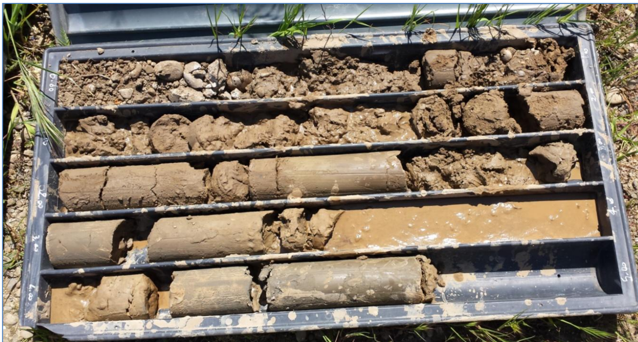
FIG. 8.B STRATIGRAFIA DA 0 -5 M - SONDAGGIO S3
