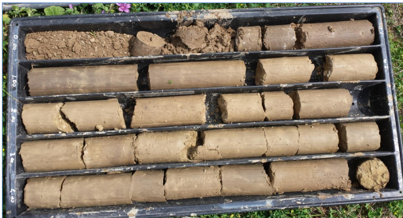
FIG. 25B.- STRATIGRAFIA DA 0 -5 M – SONDAGGIO S18
