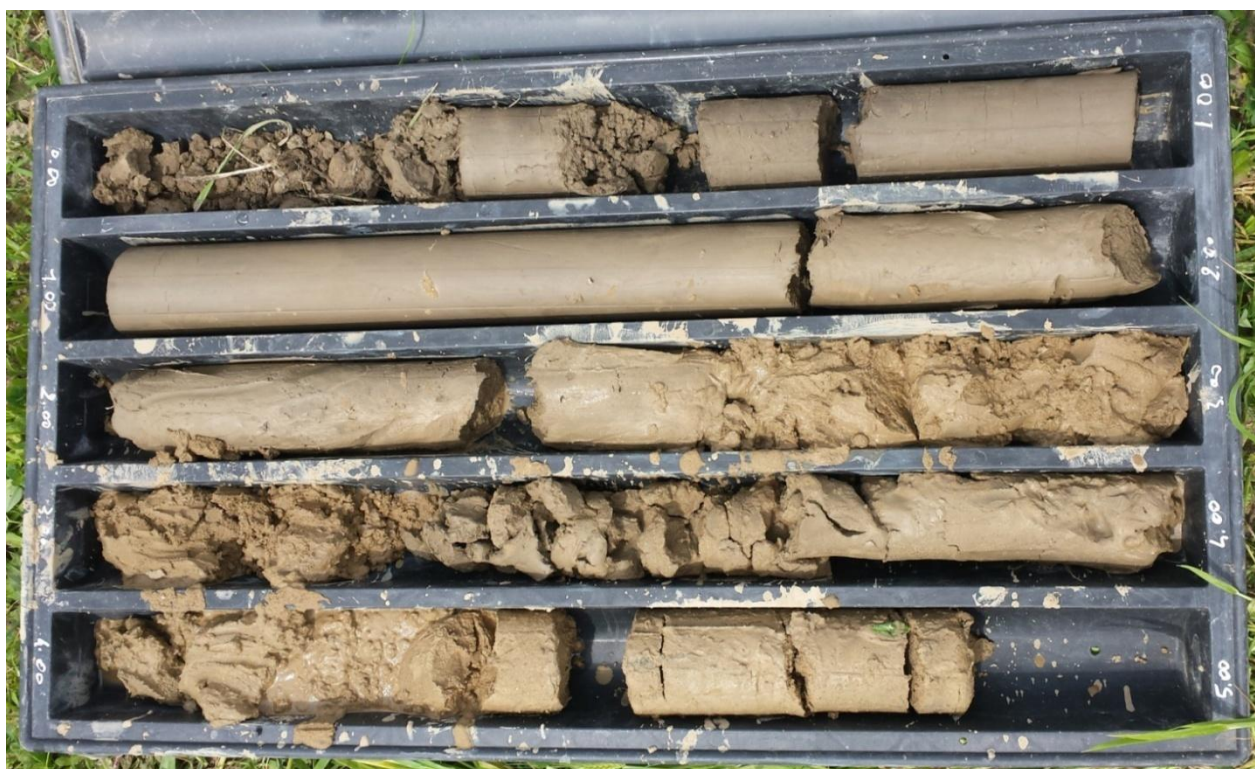
FIG. 16B STRATIGRAFIA DA 0 -5 M - SONDAGGIO S10
