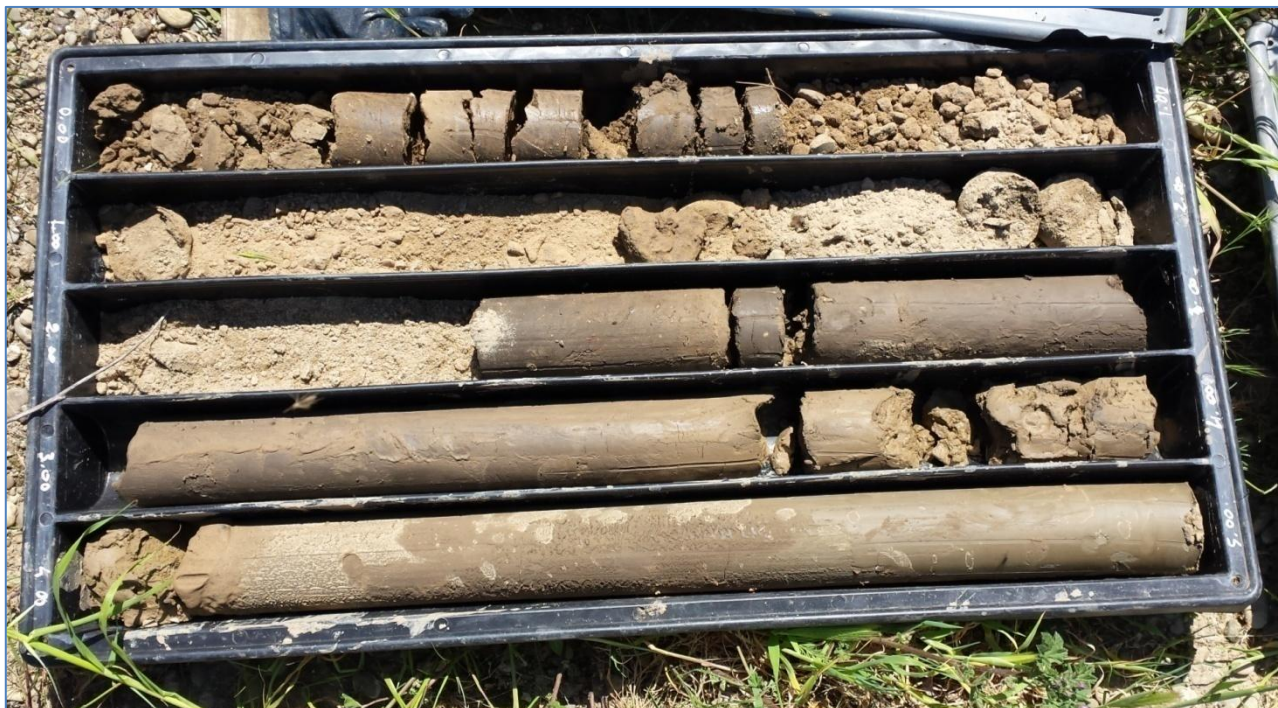
FIG. 6B STRATIGRAFIA DA 0 -5 M – SONDAGGIO S1
