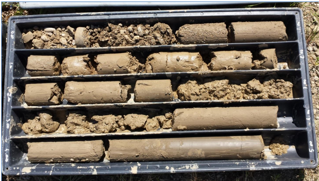
FIG. 9.B STRATIGRAFIA DA 0 -5 M - SONDAGGIO S4
