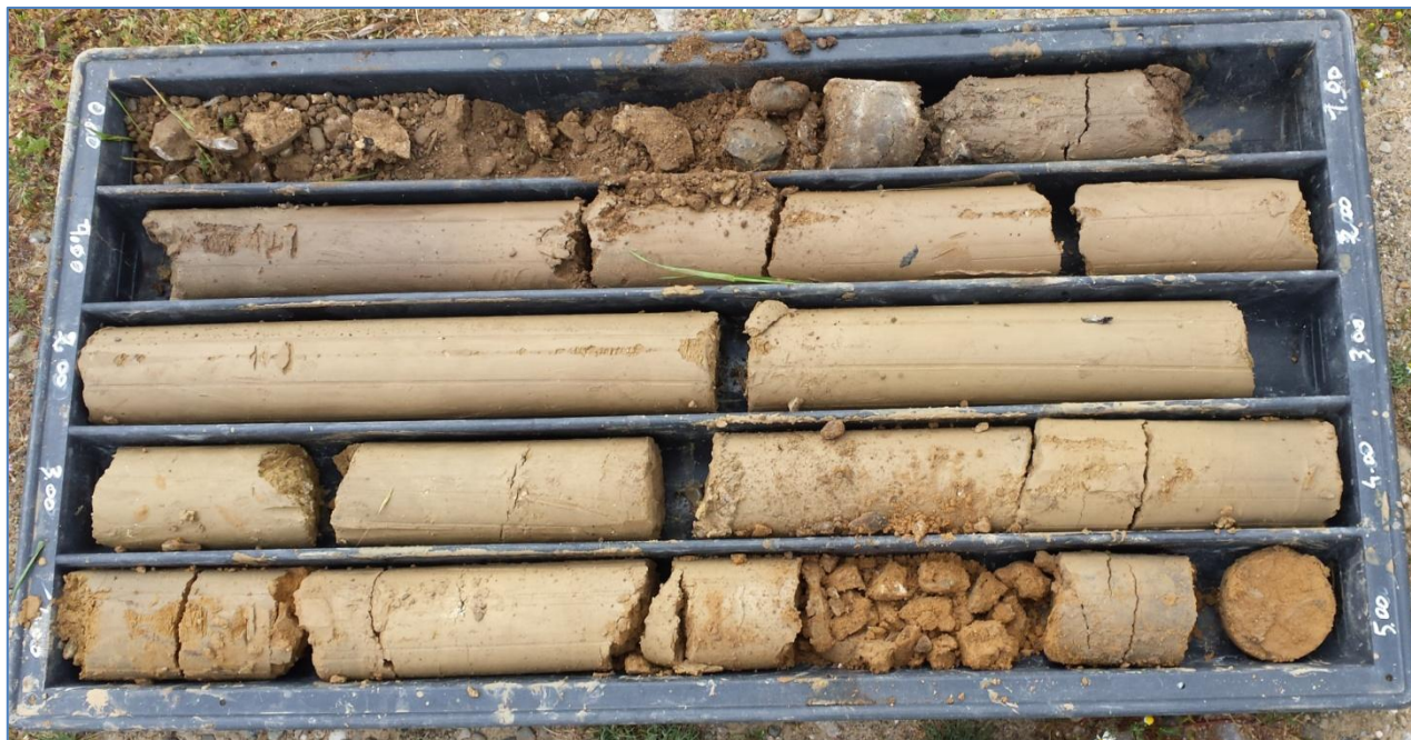
FIG. 22B - STRATIGRAFIA DA 0 -5 M - SONDAGGIO S15
