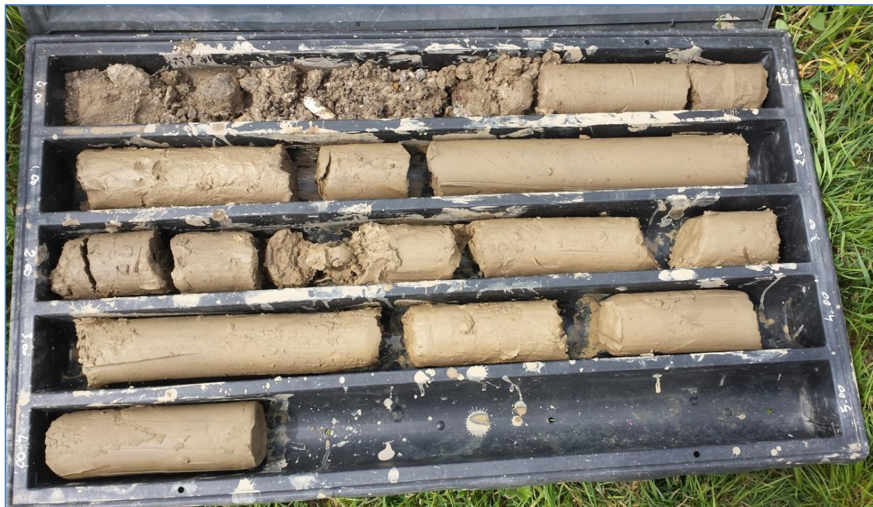
FIG. 14 B STRATIGRAFIA DA 0 -5 M - SONDAGGIO S9
