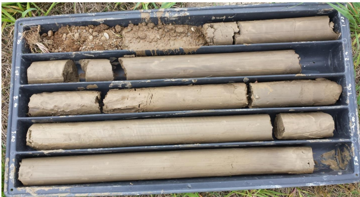
FIG. 18B STRATIGRAFIA DA 0 -5 M - SONDAGGIO S12
