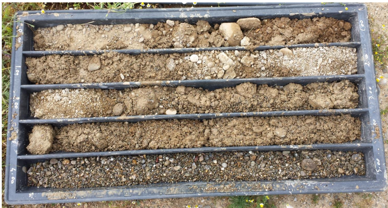
FIG. 24B.- STRATIGRAFIA DA 0 -5 M – SONDAGGIO S17
