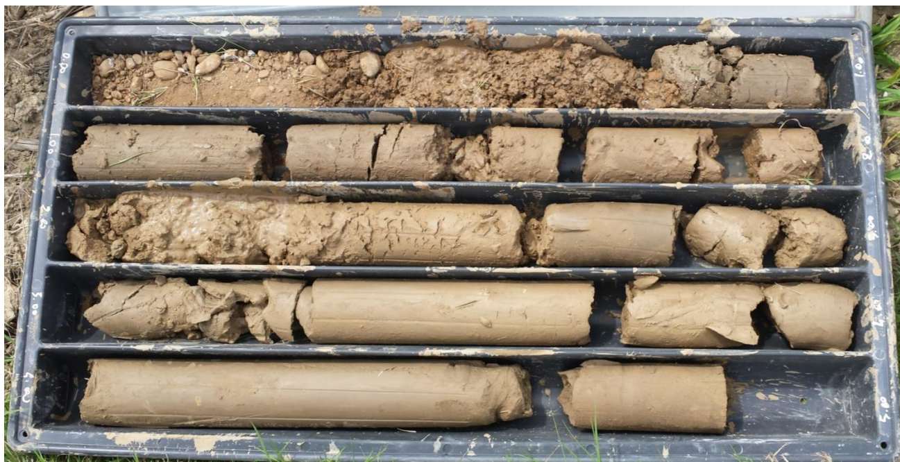
FIG. 17B STRATIGRAFIA DA 0 -5 M - SONDAGGIO S11
